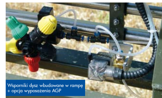
Cyrkulacja ciągła z układem AGP (pneumatyczny układ zapobiegania kapaniu)
